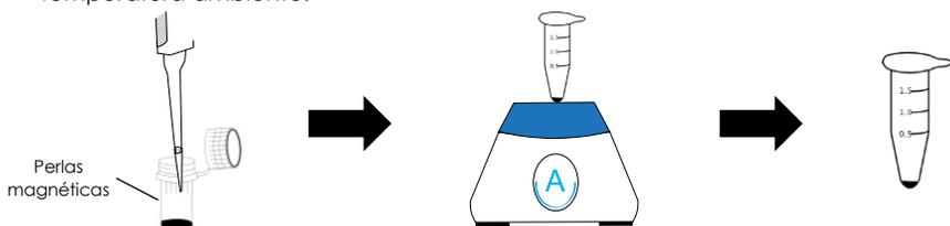
VI. Coloque el tubo en una gradilla magnética, déjelo en esa posición hasta que la mezcla se aclare (aproximadamente 1-2 minutos), posteriormente retire completamente el sobrenadante sin quitar el tubo de la gradilla y sin llevarse las perlas magnéticas.
