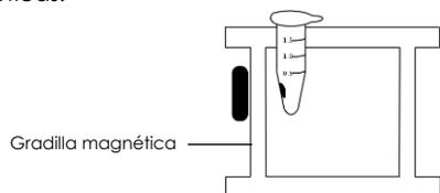
VII. Después agregue 500  $\mu\text{L}$  de buffer de lavado y mezcle por vortex durante 10 segundos luego regrese el tubo a la gradilla magnética y déjelo hasta que la mezcla se aclare (aproximadamente 1-2 minutos), proceda a remover el sobrenadante sin retirar el tubo de la gradilla y sin llevarse las perlas magnéticas. Evite dejar residuos.
